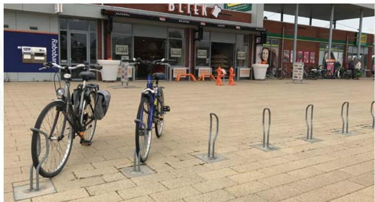
**Einzelparker zum Einbetonieren**
