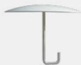
**Stahlkappe mit Betonanker**
