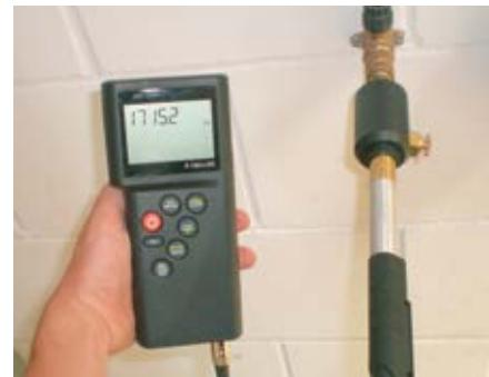
Restfeuchtefühler für Druckluftanlagen
